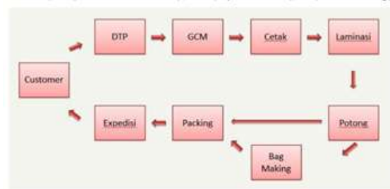
Gambar 1 Alur proses produksi pada PT X Sumber : Dokumen pribadi
