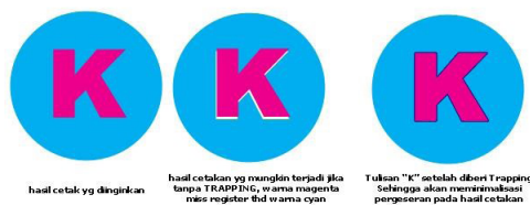
Gambar 7. Trapping untuk meminimalkan misregister cetakan Sumber : https://www.lumi.com/quality/trapping
