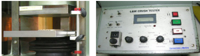
Gambar 3.2. Proses FCT dan Angka Tenaga Tekanan
